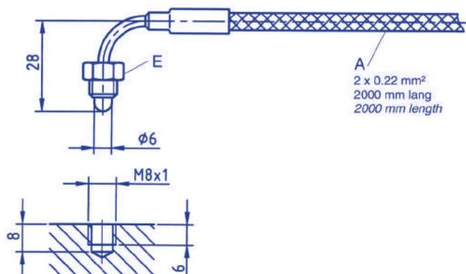
Beispiele Thermoelemente für Kunststoffverarbeitungsmaschinen
