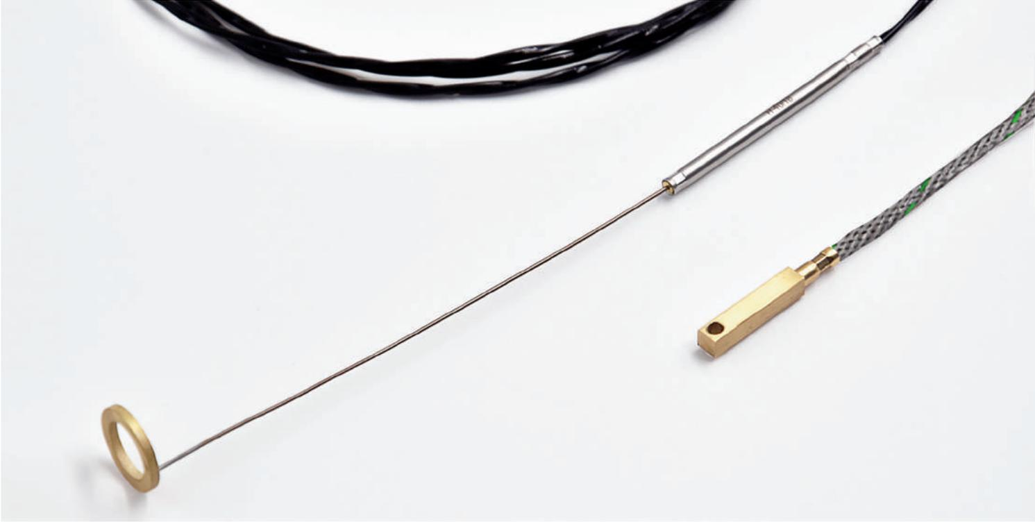
Die Oberflächenfühler sind für die Messung von Oberflächentemperaturen angepasste Thermoelemente. Die Schutzhülsen besitzen eine große Oberfläche um eine gute Wärmeübertragung zu gewährleisten, durch vorhandene Bohrungen können sie dauerhaft auf die Oberfläche geschraubt werden. Auch gefederte Messspitzen sind möglich.
