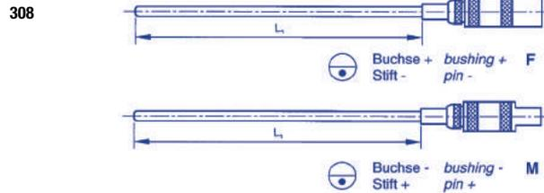
Mantelthermoelemente mit Kabel
