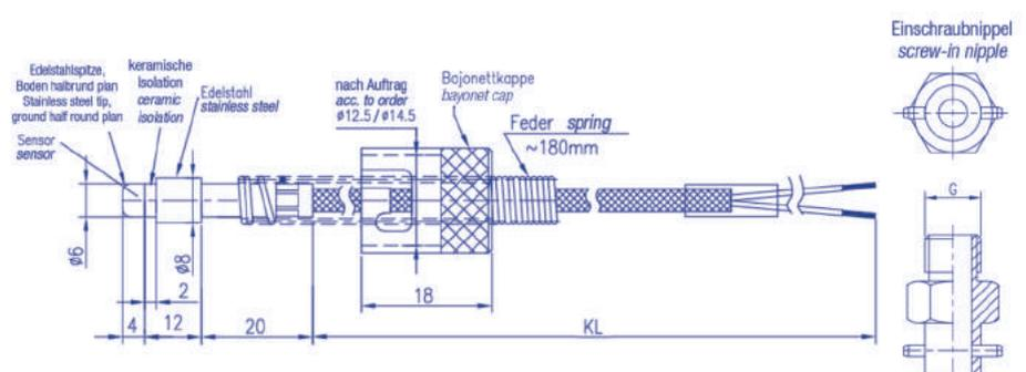
Beispiele Thermoelemente für Kunststoffverarbeitungsmaschinen
