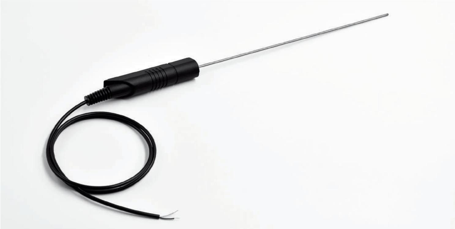
Die Fühler sind mit den Paarungen NiCr-Ni (K), Fe-CuNi (J) nach IEC 60584-1 bzw. Fe-CuNi (L) nach DIN 43710 (zurückgezogen) erhältlich. Der angegebene Einsatztemperaturbereich bezieht sich auf den sensitiven Teil an der Messspitze. Für die max. zulässige Temperatur am Griff und der Anschlussleitung gelten die werkstoffabhängigen Kennwerte.
