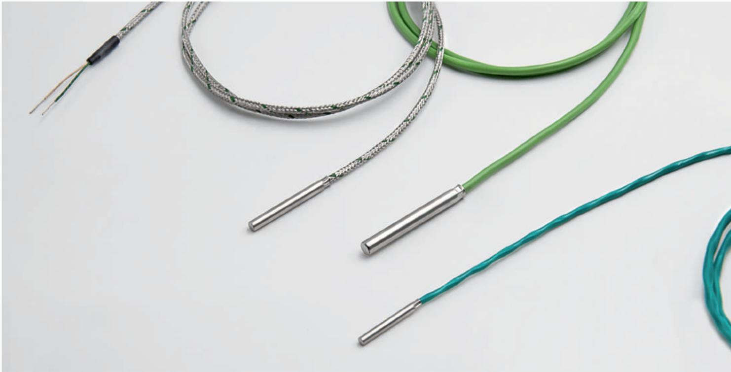
Diese Fühler ermöglichen die Erfassung von Temperaturen in flüssigen und gasförmigen Medien. Bei Hülsenthermoelementen bietet die Tauchhülse einen mechanischen und chemischen Schutz des Thermoelementes. Reine Kabelthermoelemente mit freiliegender Schweißperle sind empfindlicher, besitzen jedoch eine kürzere Ansprechzeit.
