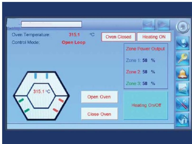
Wenn eine Regelung mit geschlossenem Regelkreis vom Heizsystem verwendet wird, stellen wir sicher, dass die PID-Funktion so abgestimmt ist, dass eine Temperaturregelung mit engen Toleranzen möglich ist. Die Bereitstellung von „Schnellanschluss“-Steckern und -Steckdosen am Heizungs- und Steuersystem ermöglicht eine kurze Installationszeit mit minimalem Bedarf an qualifiziertem Elektrpersonal, wo immer dies möglich ist.
