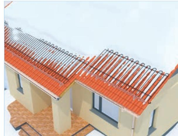
8JY'5bgW'i gg' i bX'9bXUVgW'i gga i ZYb müssen ebenfalls auf der Dachfläche verlegt werden (Brandschutz). Die Verlegung des Heizsystems ist nur auf Ziegel-, Betonziegel- und Metaldächern zulässig. Die Verlegung auf Holz-, Kunststoff-, Teer-, Asphalt-, Bitu-men- und Foliendächern ist nicht zulässig (hierbei sind selbstlimitierende Heizbänder zu verwenden – Informationen und geeignete Produkte erhalten Sie auf Anfrage).
