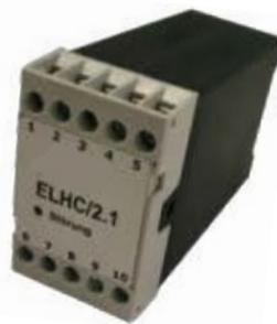
Das Heizkreisüberwachungsgerät ELHC/2 zur Überwachung von selbstregulierenden Heizleitungen besteht aus dem Überwachungsrelais ELHC/2.1 und dem Endgerät ELHC/2.2. Da das Gerät von der Betriebsspannung des Heizbandes versorgt wird, kann das Heizband nur während der Betriebszeit überwacht werden. Bei ausgeschalteter Heizung ist der Meldekontakt im Zustand „Störung“.
