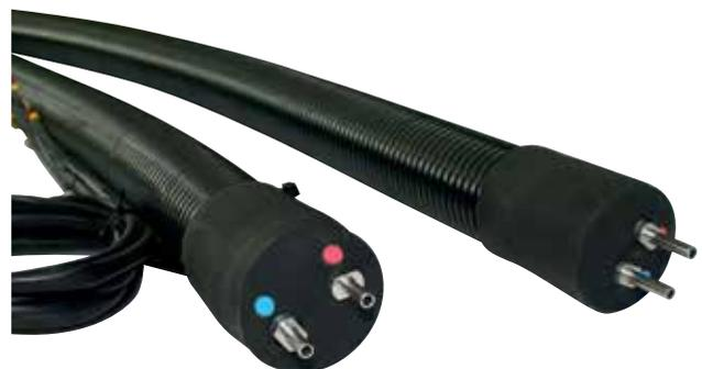
**ELH/2aw-200 °C-NW6**, Analyseheizschlauch mit 2 Innenseelen NW 6/8 aus Fluorpolymer & beidseitigem übergangslosem Spezial-RSL-Rohrstutzen. Haltetemperatur 200 °C
