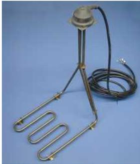
An dem Tauchbadwärmer wird ein Fühlerrohr mit einer Temperatursicherung angebracht. Das Anschlusskabel der Abdeckkappe hat zwei markierte Leitungen mehr, die auf Unterbrechung (z.B. mit dem Kontakt-schutzrelais) geprüft werden.
